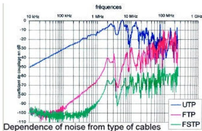
Se puede observar como entre los cables UTP y FTP, el apantallamiento deja de ser eficaz o de atenuar la EMI a partir de frecuencias alrededor de 100MHz, todo ello suponiendo que el sistema FTP está conectado a un buen sistema de tierras.
